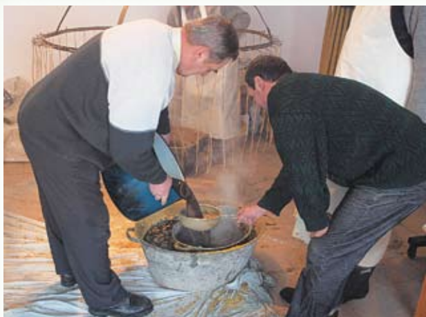
Cedzenie płynnego wosku przed przystąpieniem do odlewania świec
