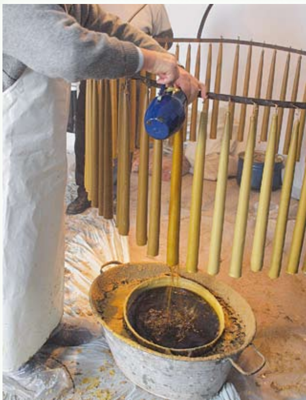
Naczynie z płynnym woskiem pływa w waniencie wypełnionej wodą, która zbiera krople rozpryskującego się wosku.
